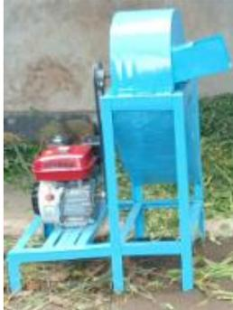
Gambar 2. Hasil rancang bangun alat mesin pencacah rumput
