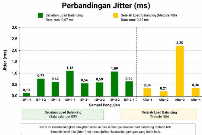
Gambar 21. Grafik Perbandingan Kinerja ISP ( Jitter ) Sebelum dan Sesudah Penerapan Metode Load Balancing NTH
